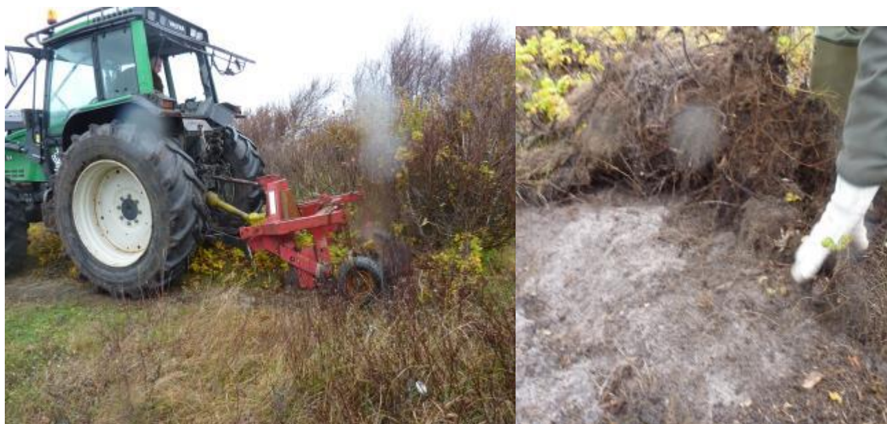
Plante-løfteren løfter rosen fri og ryster sand og jord af rødderne (fotos R. M. Buttenschøn)
