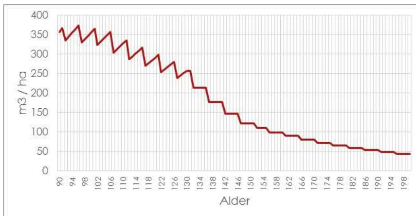
Figur 1: Afviklingsmodel for bøg. Bemærk at der ikke beregnes tilvækst fra 130 år. Ligeledes at slut massen ved endt hugst er 50 m³, som følge af politikken om at efterlade 5 træer/ha til død og henfald.
