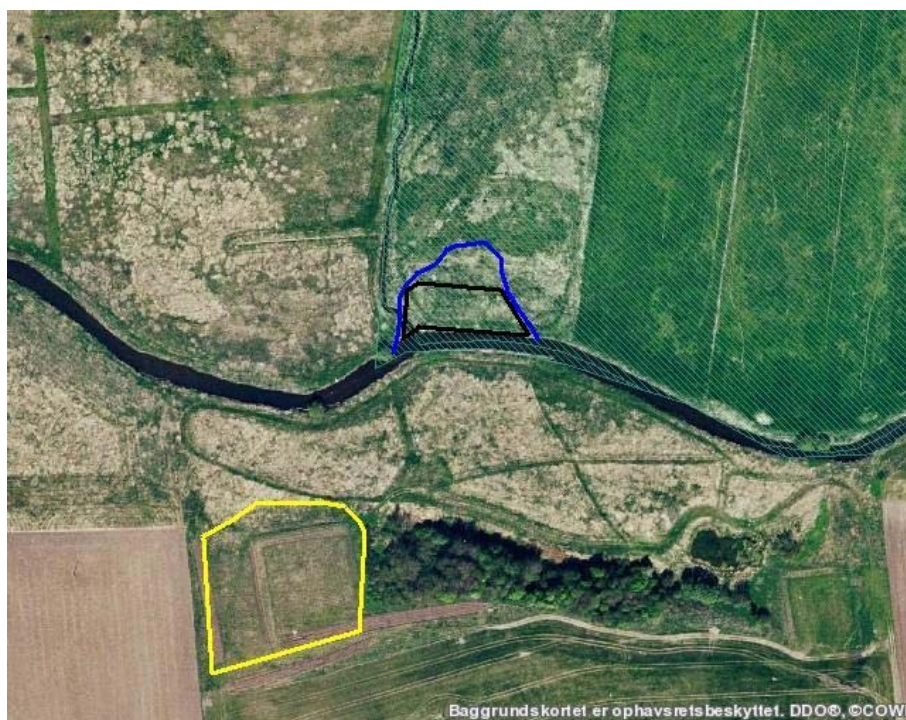
Fig. 4.3 Slyngning 4. §3 beskyttede områder, og forslag til placering af mellemedeponi (sort) og placering af overskydende jord (gult).
