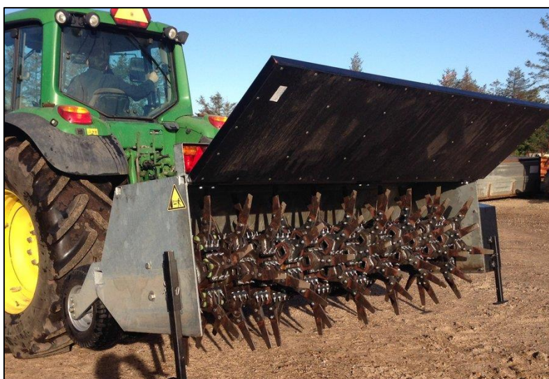
Figur 11: Biorotoren i en 2 meter udgave, som er anvendt i klitterne hos Naturstyrelsen Blåvandshuk. Foto: Lunde Maskincenter
