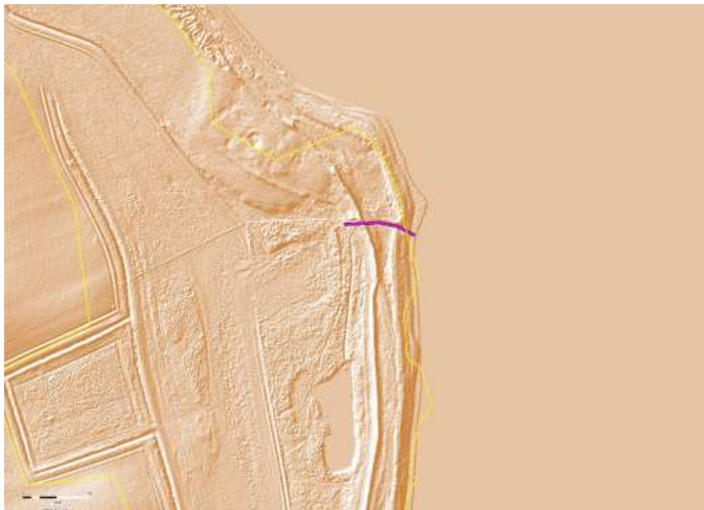
Figur 3.3.3.1 Omfang af gravekasse ved nedbringelse af rørgennemløb i havdiget for det nordlige projekt-område.
