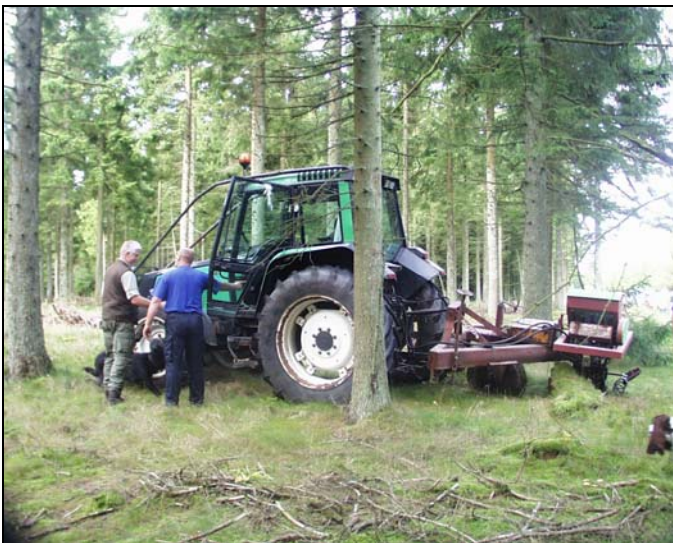
På billedet ses det udstyr, der i øjeblikket anvendes til såning af bøg under rødgran på Klosterheden distrikt. Foto: Mads Jensen.
