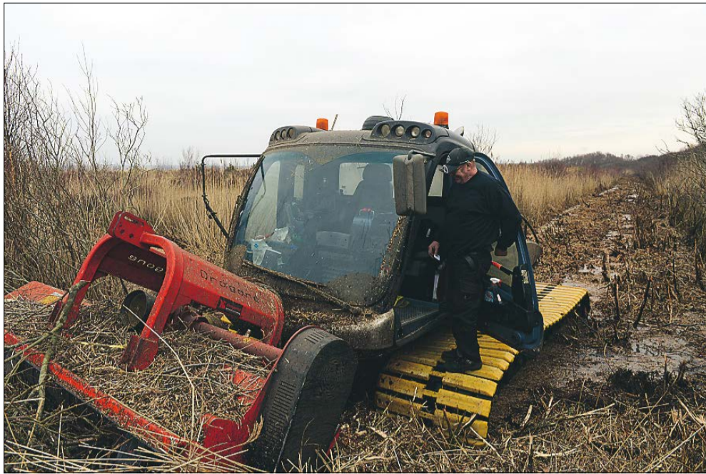
En maskine på larvefødder trykker kun med en brøkdel i forhold til en tilsvarende maskine på hjul, fortæller maskinfører Ehlert Søgaard Nielsen.
