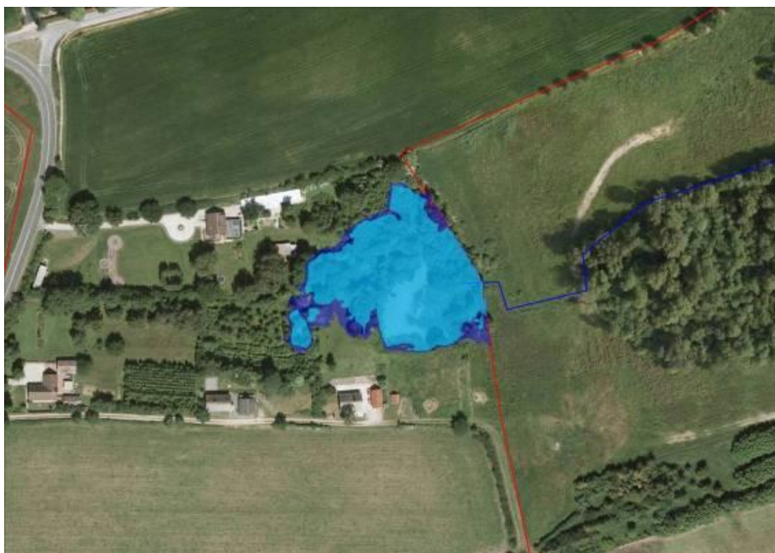
Figur 5 Vandspejl ved en sommermaks. Med mørkeblå er vist den fremtidige (kote 5,1 m) og med turkis de eksisterende (kote 4,9 m) vandspejle. Bemærk, at der kun er vist oversvømmelser uden for projektområdet på figuren. Der er store oversvømmelser indenfor projektområdet i begge situationer.
