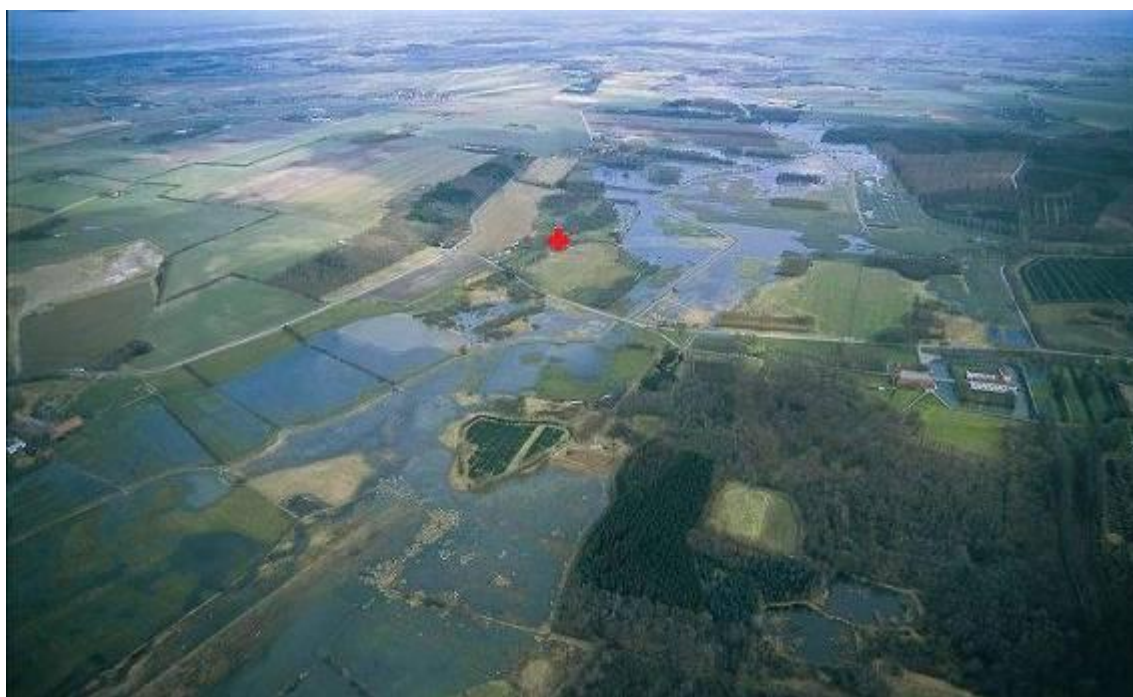
Figur 4 Oversvømmelse fra Alling Å i sommeren 2002 (kilde Århus Stiftstidende). Med rødt er vist Vasens placering. Bemærk vandspejlet langt oppe på terrænet til højre for markeringen. Vandspejlet er ca. i kote 4,7-4,8 m, hvis der sammenlignes med højdemodellen.
