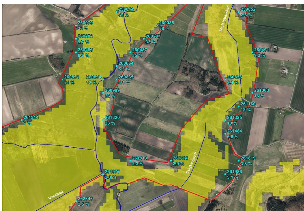
Figur 2.8.3. Figur viser prøve ID og resultater af jordens OC indhold angivet i TOC % i TS.
