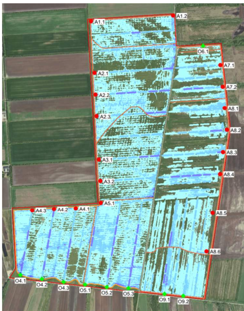
Figur 4-9 Placering af afløbsbrønde (røde) og overløb (grønne) set i forhold til den maksimale vandstand (lyseblå= 0-25 cm, mellemlå=25-50 cm og mørkere blå dybere).
