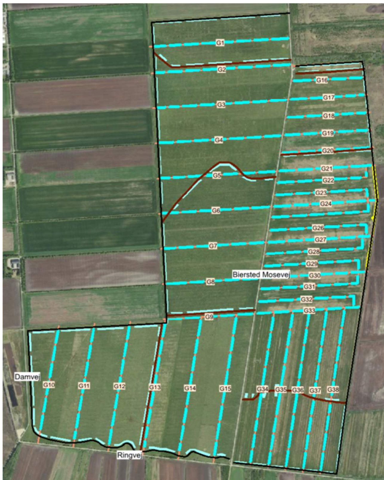
Figur 4-1 Fyldning af grøfter. Afskrab til fyld er vist med lyseblå. Gul viser en efterladt vold af tørv, der vil blive brugt til fyld. Brun er lave diger, som opdeler i delområder, mens sort viser placering af membran med randdiger.
