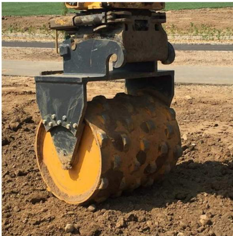
Figur 4-4 Komprimeringshjul til montering på gravemaskine https://nordjysk-lift.dk/nlshop/produkter/gravemaskine/tilbehor-til-gravemaskiner/kompri-meri
