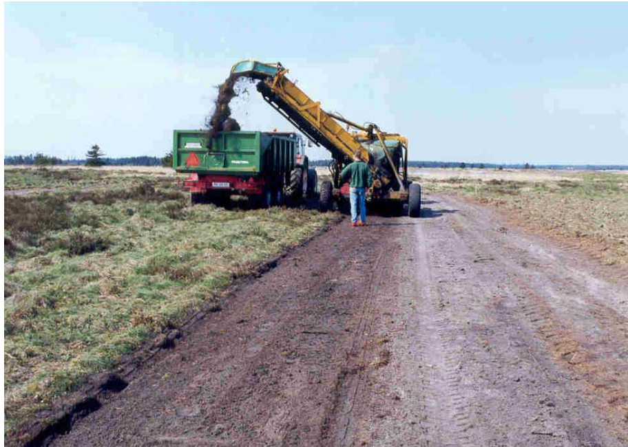
Figur 3. Afskrælning af lyngtørv på Randbøl Hede med hollandsk specialmaskine. Foto: R. M. Buttenschøn.
