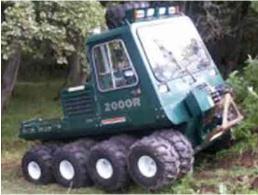
Figur 2. Scot-trac 2000 med tvillingmontage.
