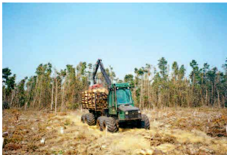
Figur 12. Stabilisering af kørevej med halm.
