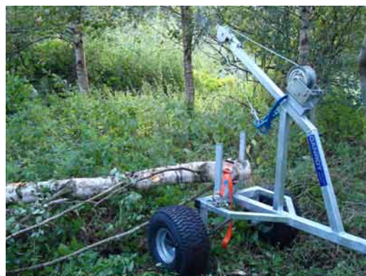
Figur 7. Udslæbningsgulv til ATV.
