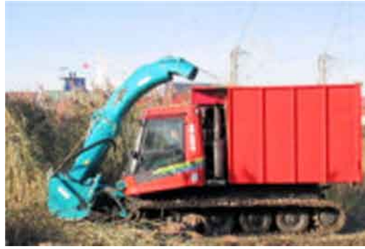
Figur 15. PistenBully med opsamling.
