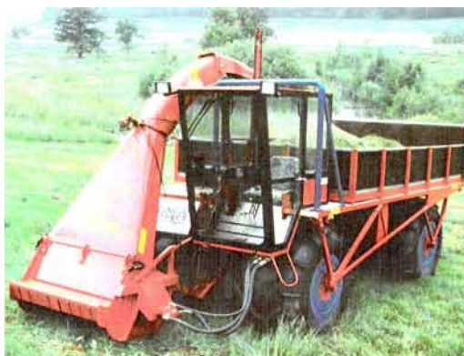
Figur 28. Seiga med slagleklipper og opsamler.
