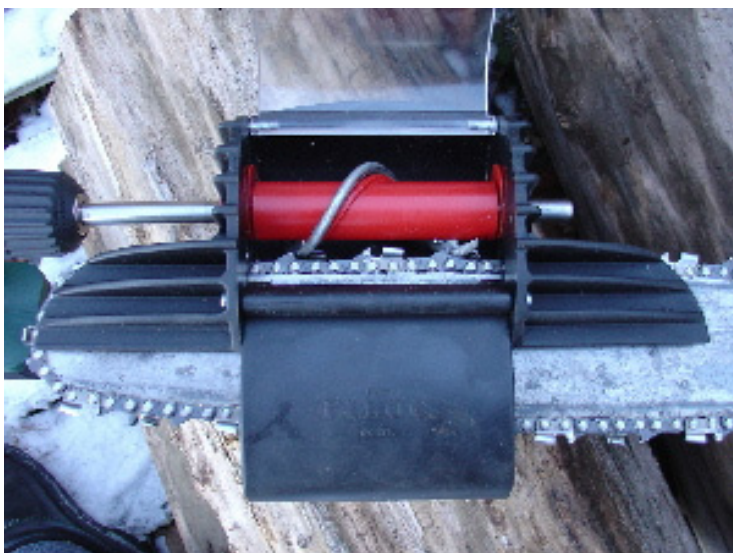
Foto: Motorsav med Filoc. Så er alt klar til slibning af savens kæde! Foto: Kåre Spang.
