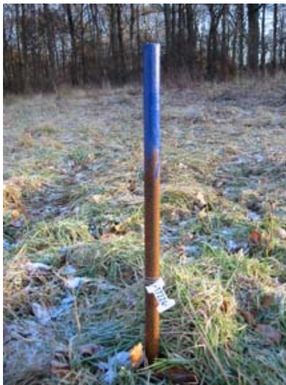
Figur 4. Eksempel på permanent afmærket jernpæl. Foto: Susanne Smerup Bak.
