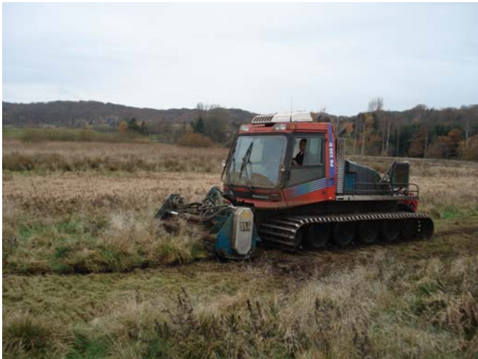
Pistemaskine med brakpudser og knuser (slagler) Ent. Per Kjær Tlf. 40333039, pris 1500 kr/time
