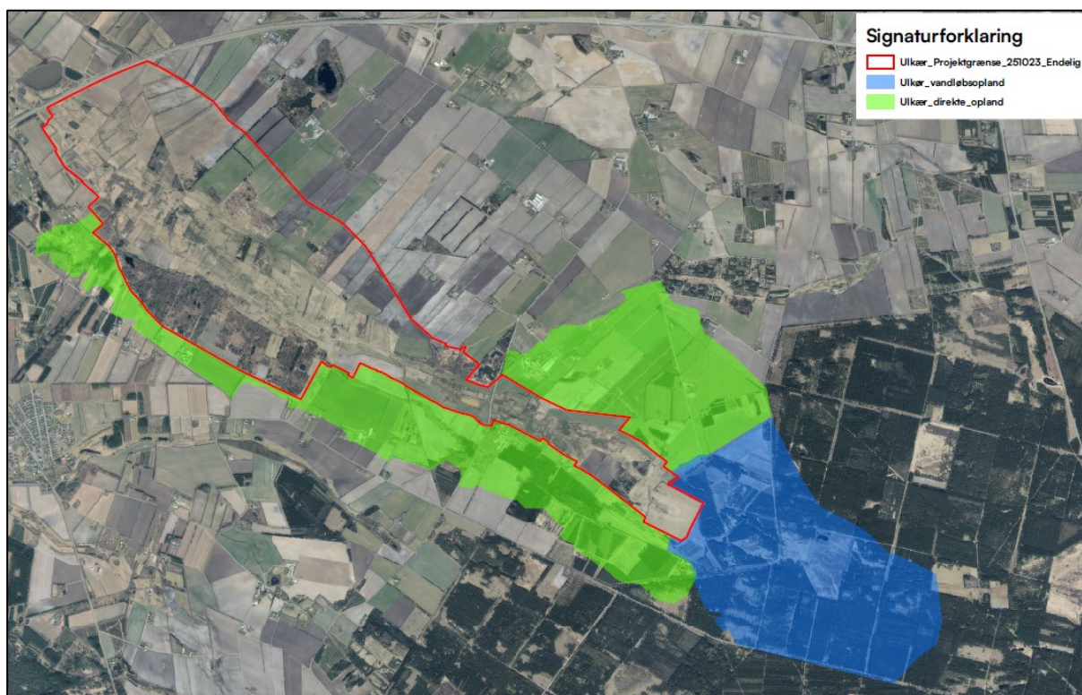
Figur 3-5 De grønne polygoner angiver det direkte opland, mens det blå angiver vandløbsoplandet.
