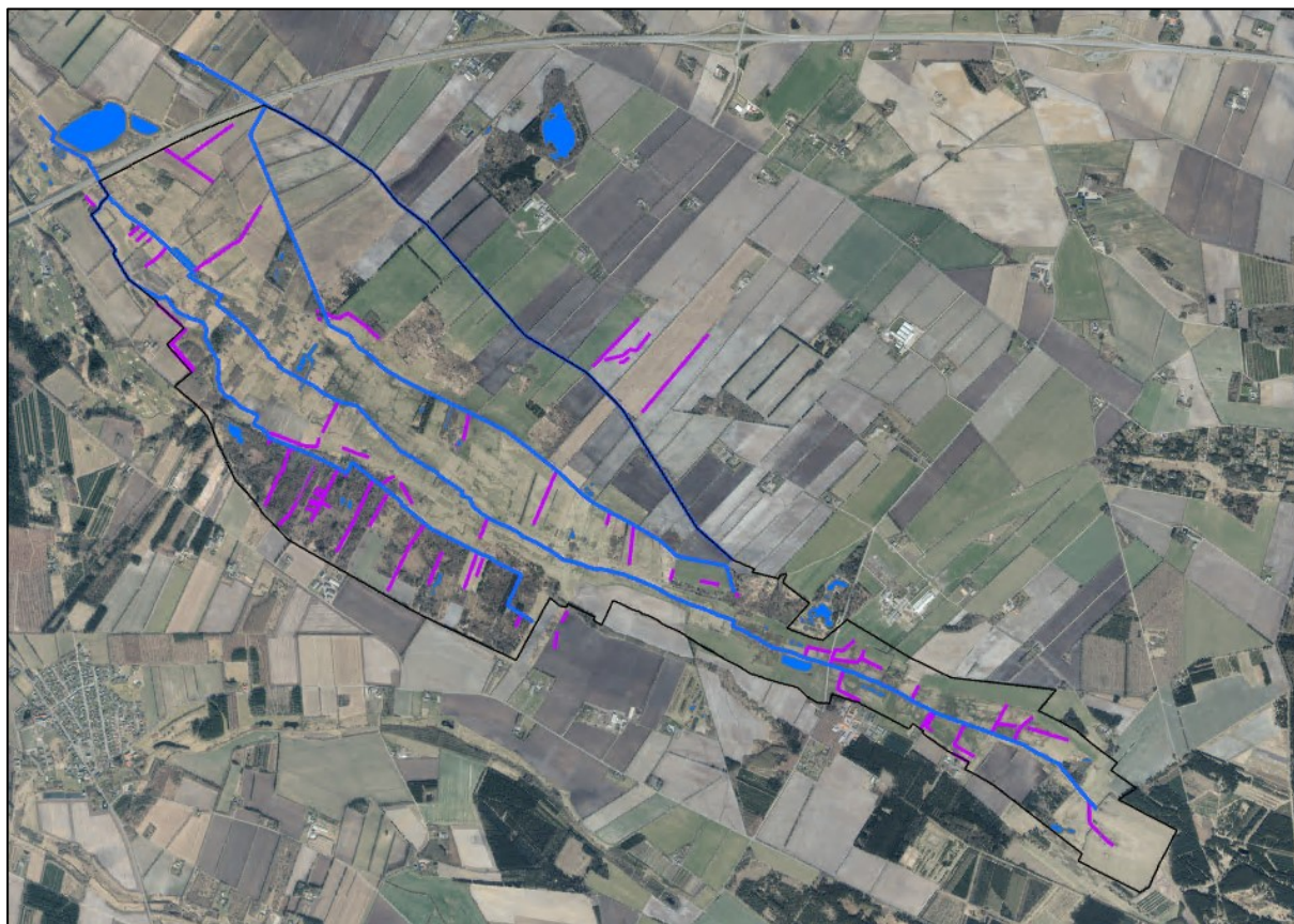
Figur 3-6 Blå linjer angiver, hvor der er anvendt vandspejlsberegninger fra beregningsprogrammet VASP, mens lilla linjer angiver, hvor der er anvendt opmålte vandspejl.
